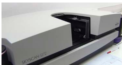
Micro Tomógrafo de Rayos-X Computarizado (MicroCT). Laboratorio utilizado por la profesora Gloria Arancibia. Departamento de Ingeniería Química y Bioprocesos, de la UC.
