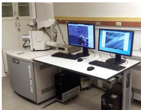
Microscopio Electrónico de Barrido. Este es uno de los microscopios más modernos del país, equipado con un cátodo de emisión de campo que permite lograr imágenes de alta resolución de objetos en la escala nanométrica. Laboratorio centralizado del CIEN-UC.
