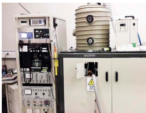
Cámara de alto vacío para evaporación con haz de electrones. Este sistema permite evaporar capas ultra delgadas de hasta seis materiales distintos en el mismo ciclo vacío. Laboratorio utilizado por el profesor Samuel Hevia.
