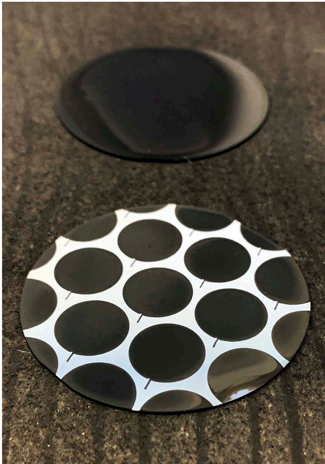
Obleas de silicio que contiene nanotubos de carbono cultivados selectivamente utilizando una máscara de evaporación.
